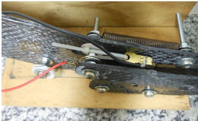
Figura 22: Mecanismo de carregamento e descarregamento utilizado para análise experimental. (Neto, 2012).
