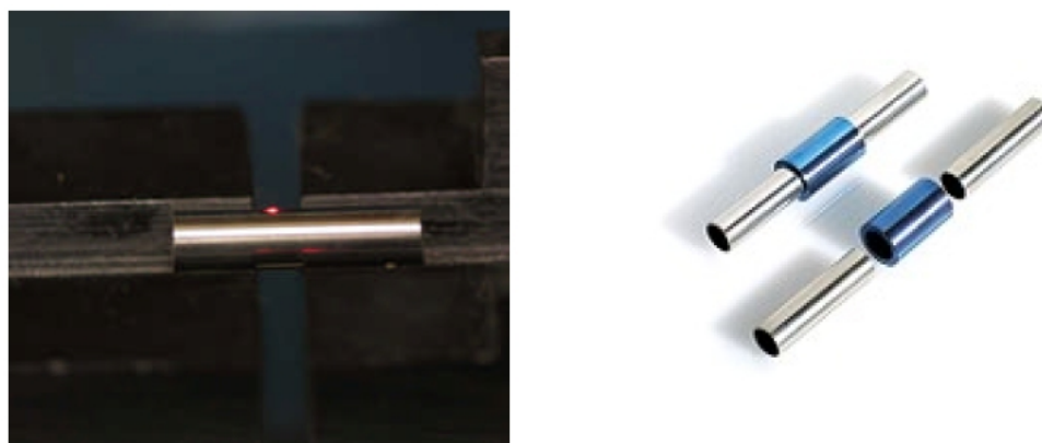
Figura 24: Acoplamento de tubos com união de SMA (Pereira, 2009)
